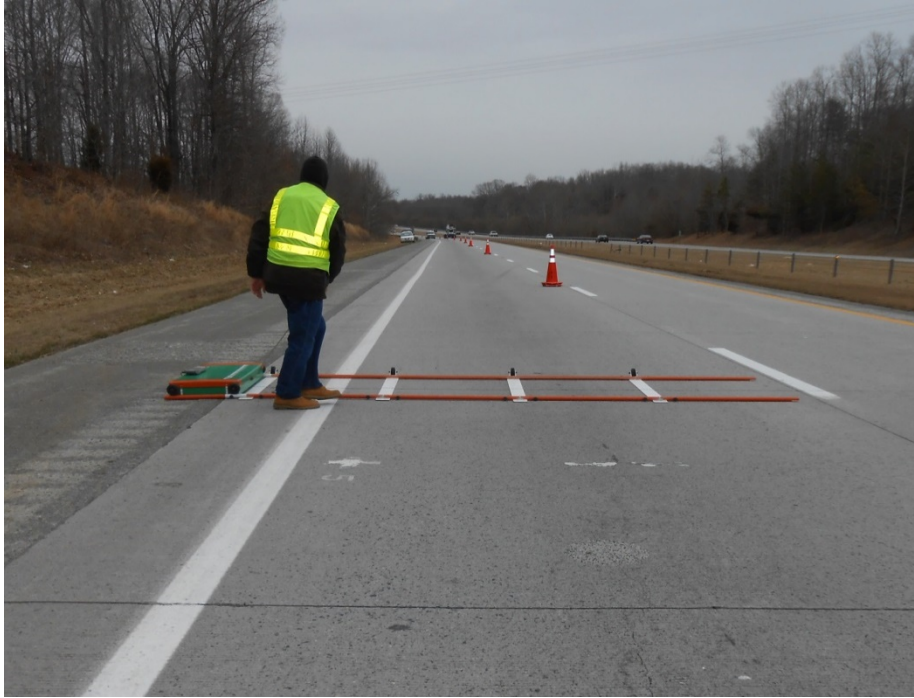
Figure 5. Photo. MIT scanning of North Carolina LTPP test section 37_0207.
