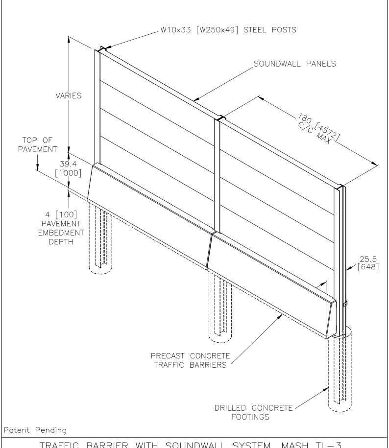
TRAFFIC BARRIER WITH SOUNDWALL SYSTEM, MASH TL-3
