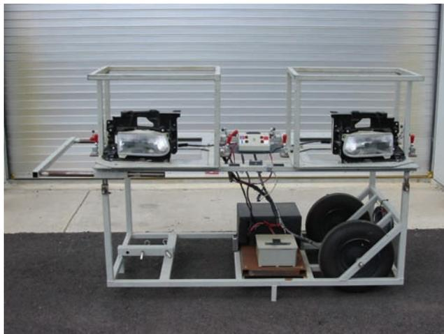
**Figure 16. Photo. Glare rack mount.**
